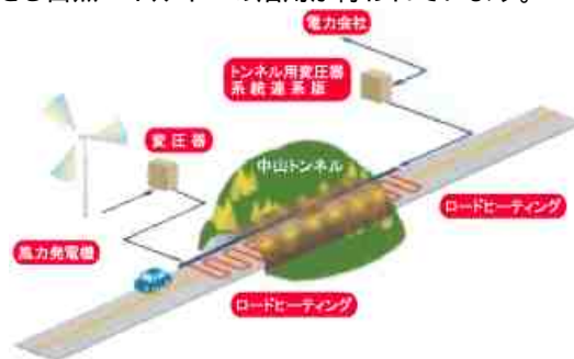
出典:国土交通省東北地方整備局 郡山国道事務所資料 <国道49号中山トンネルの風力発電を用いた消融雪設備の概要>
