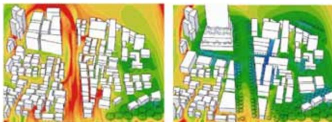
緑による冷却効果、風の流れのシミュレーション例
